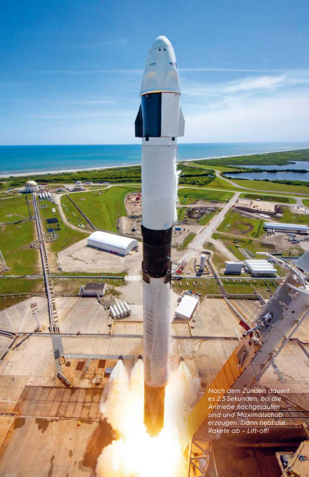
*Nach dem Zünden dauert es 2,5 Sekunden, bis die Antriebe hochgelaufen sind und Maximalschub erzeugen. Dann hebt die Rakete ab - Lift-off!*
