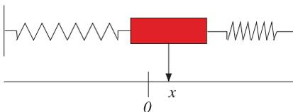
**Bild 5.5** Horizontales Federpendel
