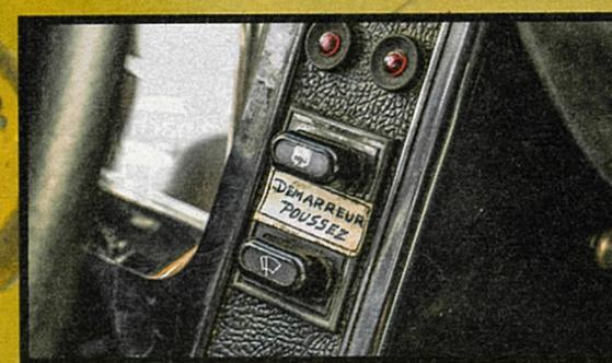
„Anlasser drücken“ steht in Französisch auf dem Schalter, der eigentlich die Bremsflüssigkeit kontrolliert. Darunter der Scheibenwischer-Schalter
