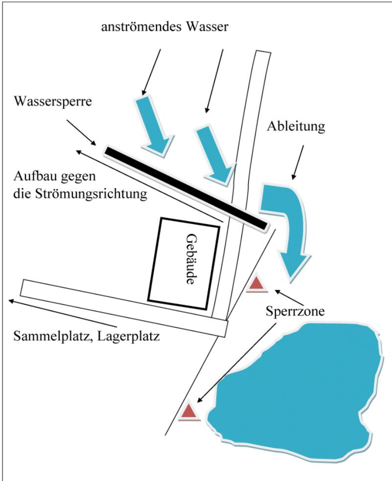
Ableitung anströmenden Wassers (schematische Darstellung)
