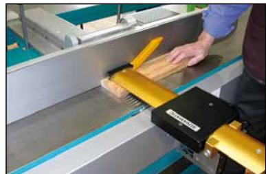
**Bild 5: Betriebliche Sicherheitseinrichtung, Messerwellenabdeckung bei einer Abrichthobelmaschine**
