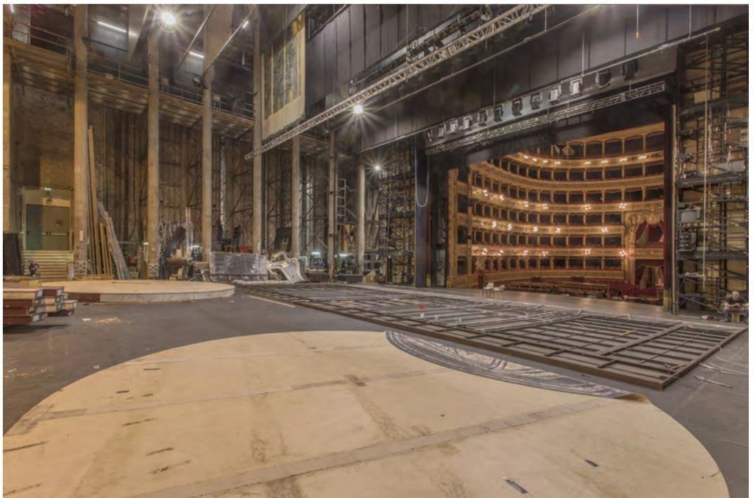
Theaterzügen der Obermaschinerie ermöglicht einen schnellen Dekorationswechsel in die Höhe des Schnürbodens. Dies setzt allerdings für das Bühnenbild flache Theatermalerei, ganz im traditionellen Sinne voraus. Seiten- oder Hinterbühne für plastisch gebaute Dekorteile, ohne die ein modernes Haus nicht auskommt, waren nicht vorgesehen.
