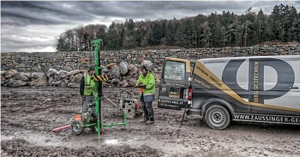
Abb. 38: Die Tragfähigkeit des Bodens wird vom Geotechniker untersucht. Bildquelle: Baumeister DI Anton Zaussinger / IBBG.at
